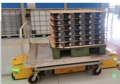
负载移动机器人、电动助力轮车行走专用动力轮模组。 Load mobile robot, special power wheel module of electric booster wheel.
